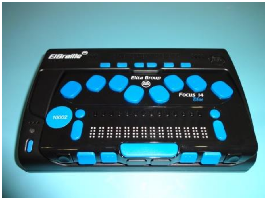
Портативный компьютер с вводом/выводом шрифтом Брайля и синтезатором речи EIBraille-W 14J G2
