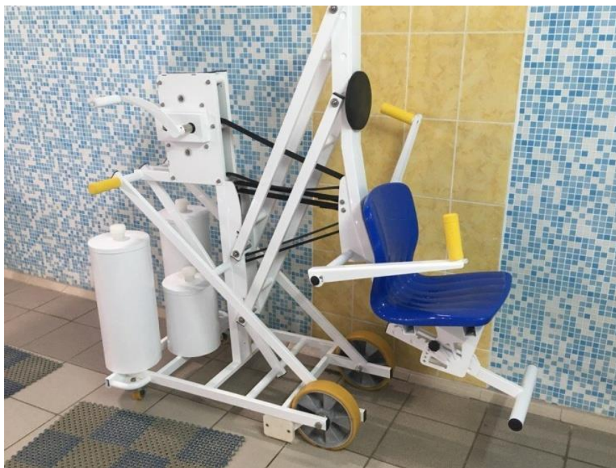
Мобильный подъемник в бассейн
