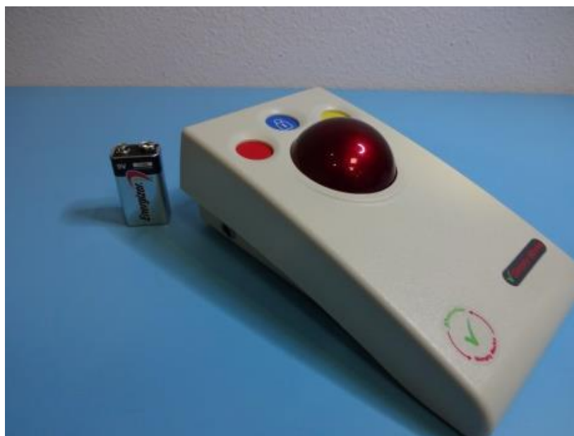
Роллер компьютерный Trackball SimplyWorks (беспроводной)
