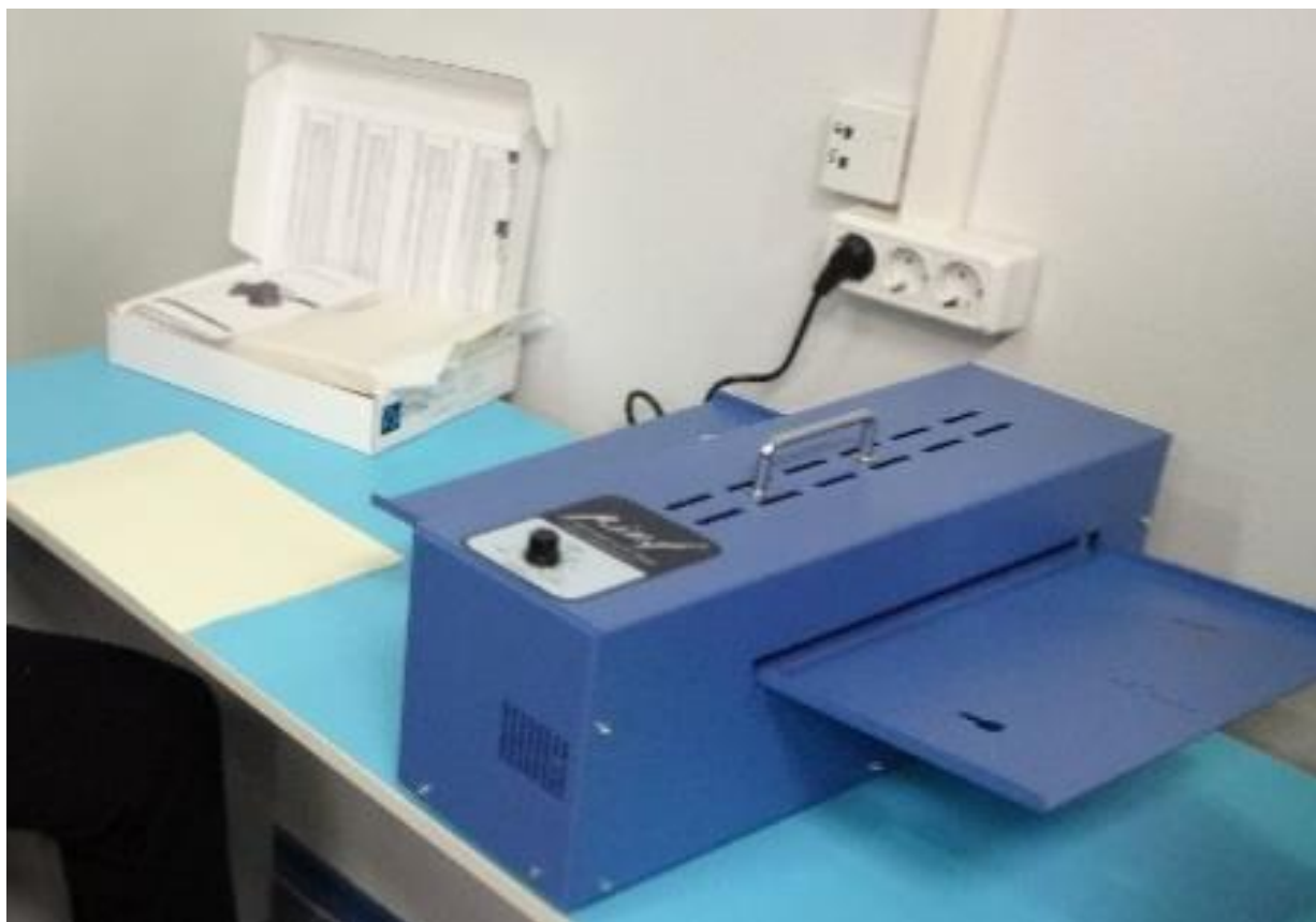
Устройство для печати тактильной графики PIAF
