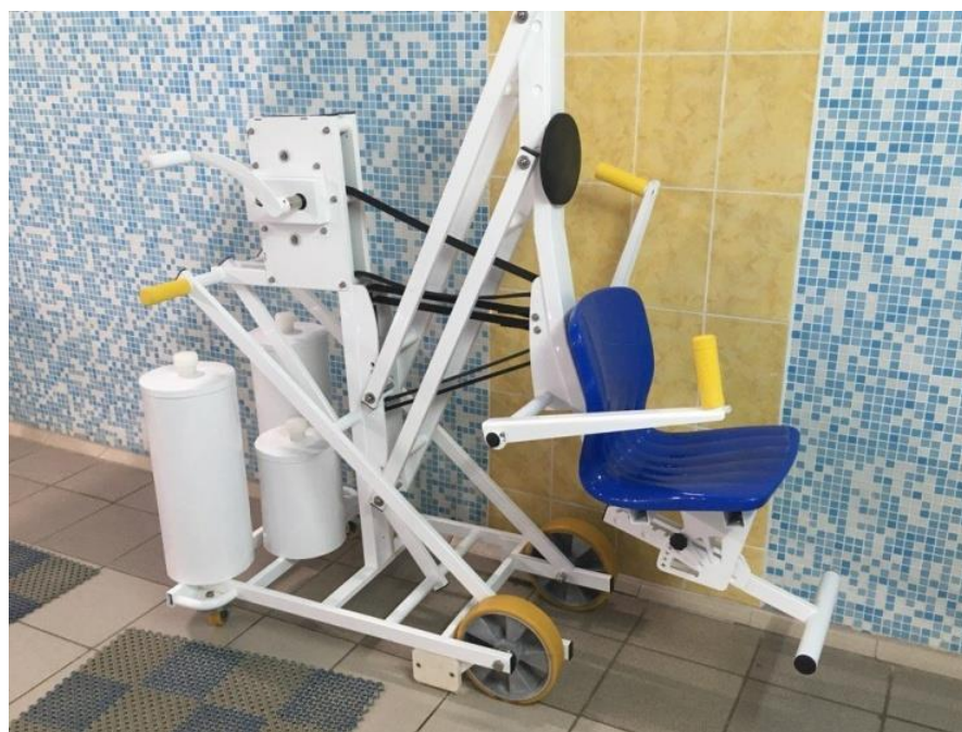
Мобильный подъемник в бассейн
