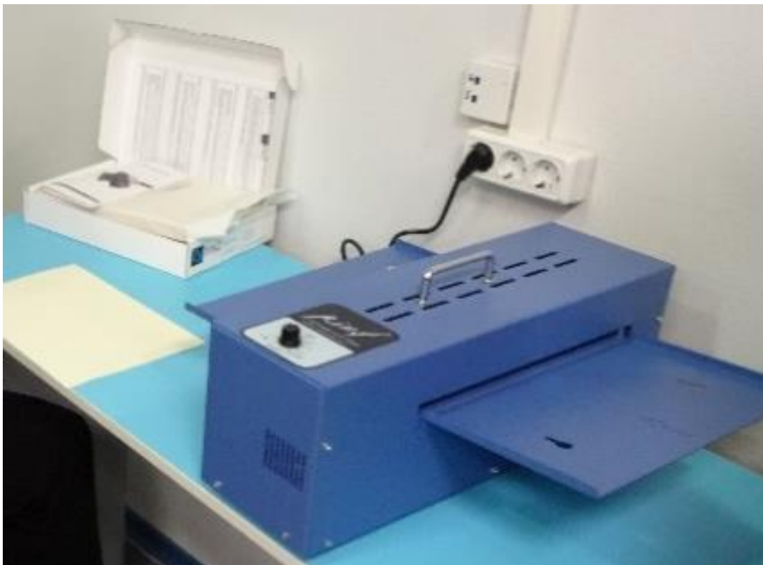
Устройство для печати тактильной графики PIAF
