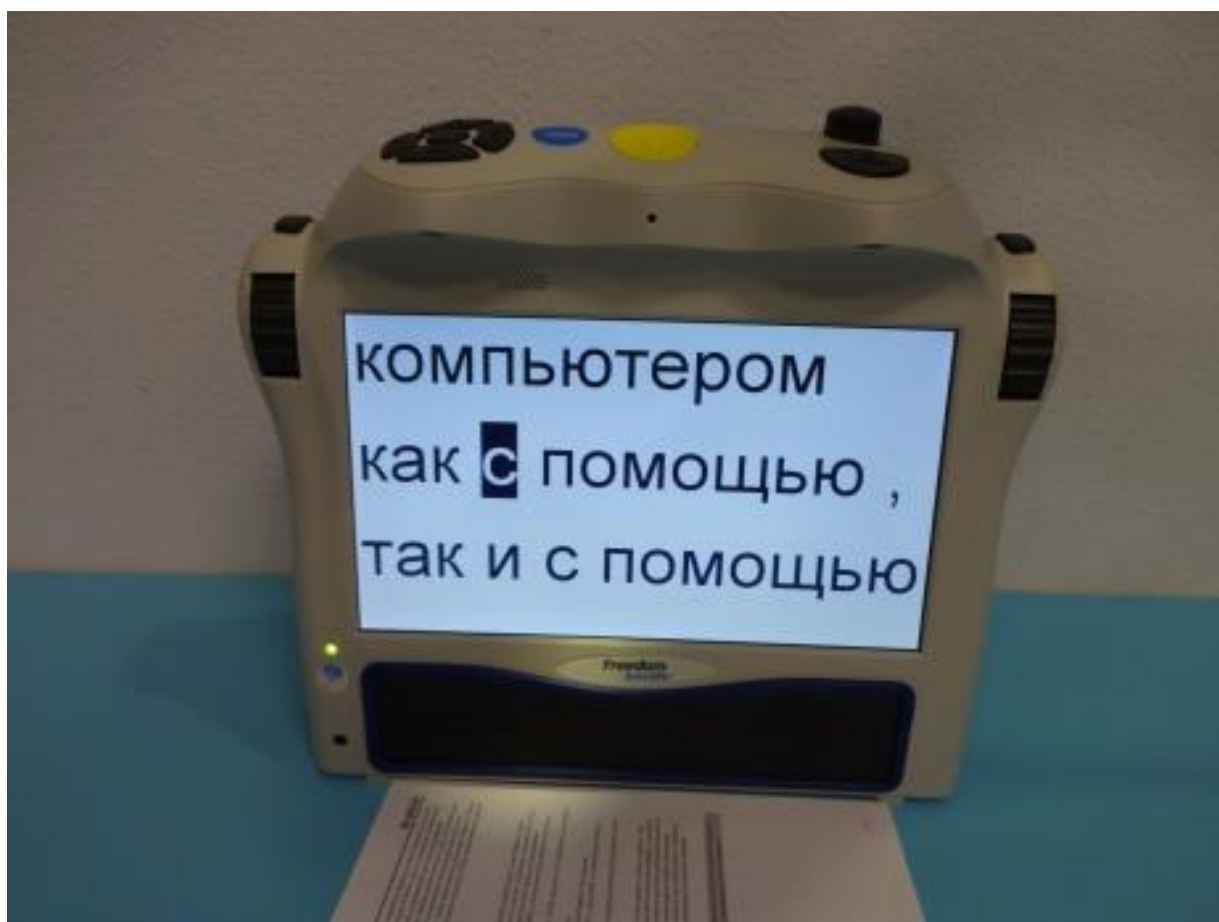
Портативное устройство для чтения/увеличения «Eye-Pal Ace»
