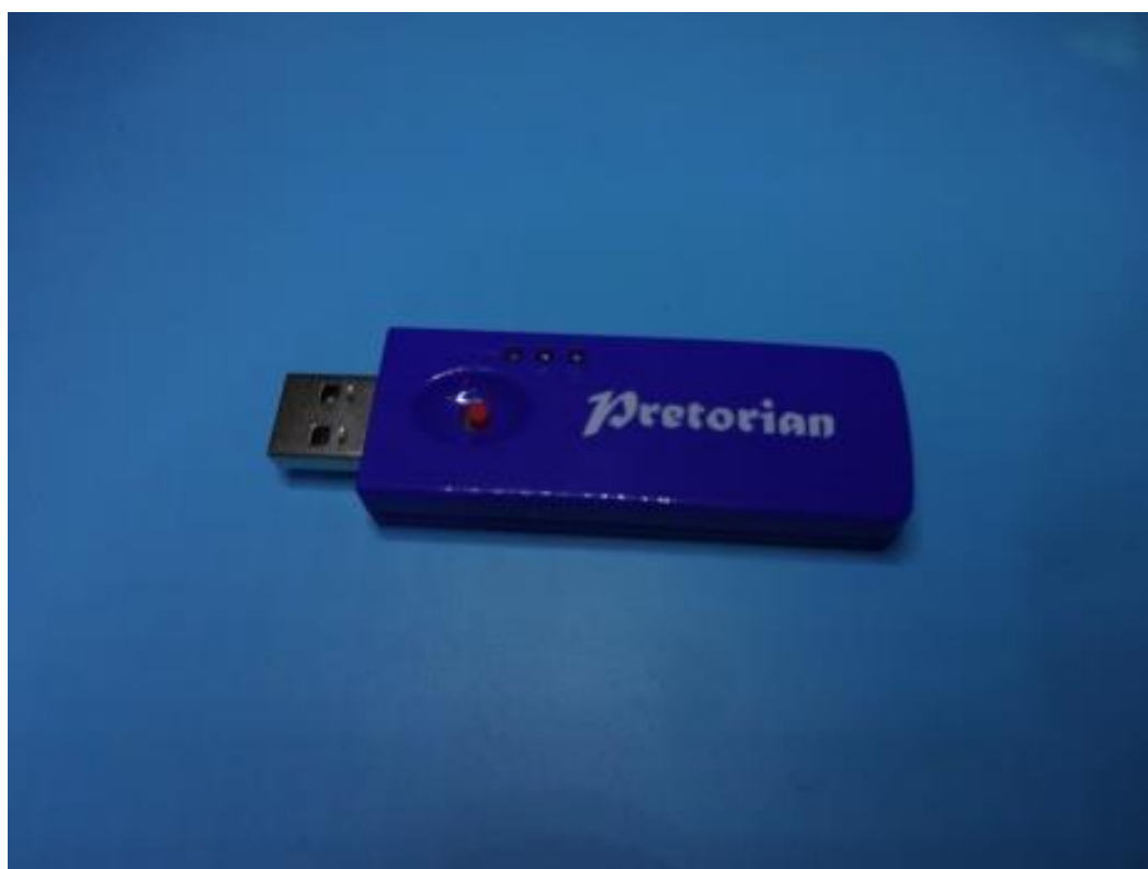
Ресивер SimplyWorks Receive 2 для беспроводной связи
